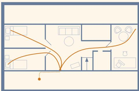
Eine Zentralstaubsaugeranlage in ein fertiges Haus zu installieren ist selten mit Problemen verbunden. In dieses 1,5 Etagen Einfamilienhaus (180 m<sup>2</sup>) platzierte man die Zentraleinheit in der Waschküche und nutzte den Besenschrank in der unteren Wohnung samt Stauräumen in der oberen Wohnung um die flexible Saugleitung einzuziehen. Mit einer Saugdose pro Etage erreicht man dann zudem jede Ecke und jeden Winkel im Haus.
